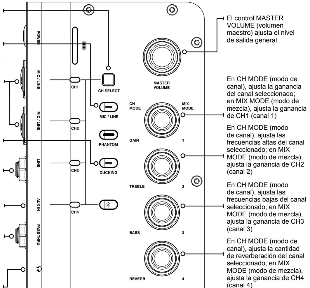
**\*NOTA:** Cuando el botón DUCKING (reducción del sonido) está habilitado, los canales 1 y 2 proporcionan la señal de cadena lateral para el ducker, que atenuará automáticamente los niveles de señal del canal 4 (AUX y Bluetooth) siempre que la señal esté presente en cualquiera de las entradas de MIC. Esta característica es ideal para la reducción del sonido de la reproducción de música durante presentaciones e instrucciones.
