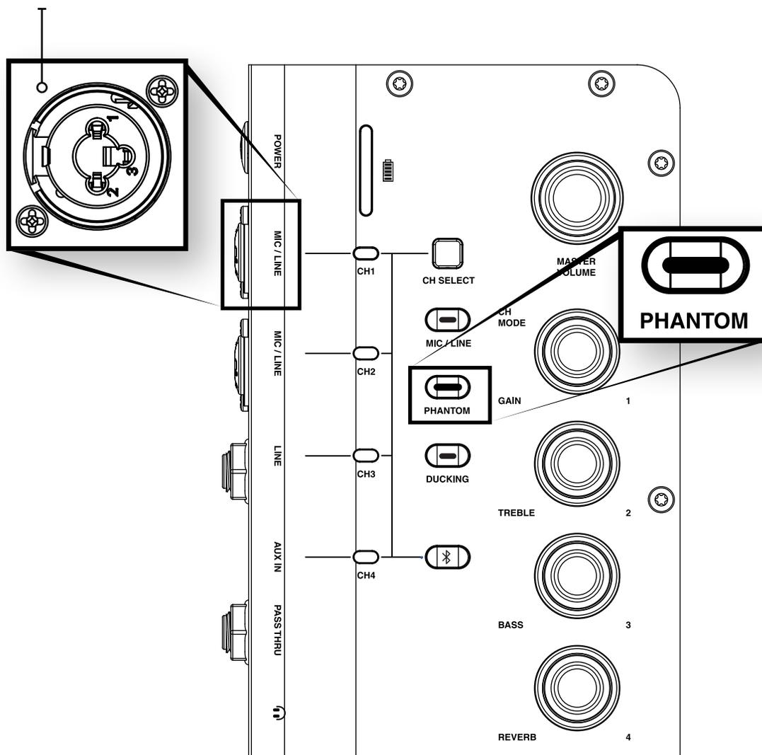
**¡ADVERTENCIA!** No conecte ninguna fuente no balanceada a la entrada CH1 XLR MIC cuando la alimentación fantasma esté habilitada. Hacerlo podría dañar el dispositivo conectado debido al voltaje de la alimentación fantasma en los pines 2 y 3 del conector XLR.
